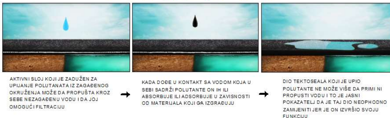
Slika 2. Prikaz načina funkcionisanja Tektoseal Active sistema
