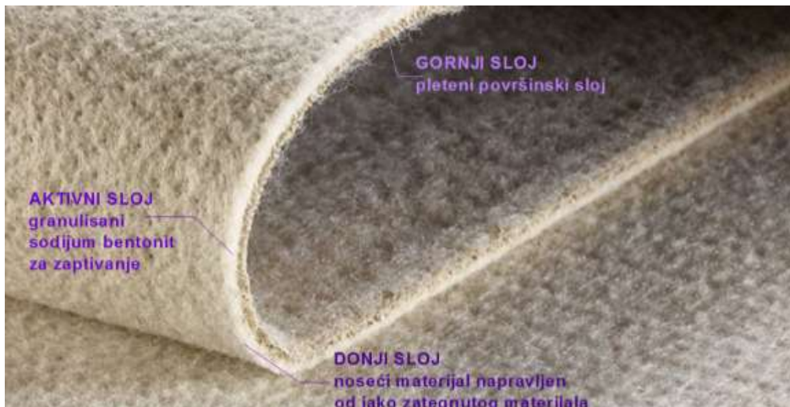
Slika 8. Prikaz sastava Tektoseal Clay sistema
