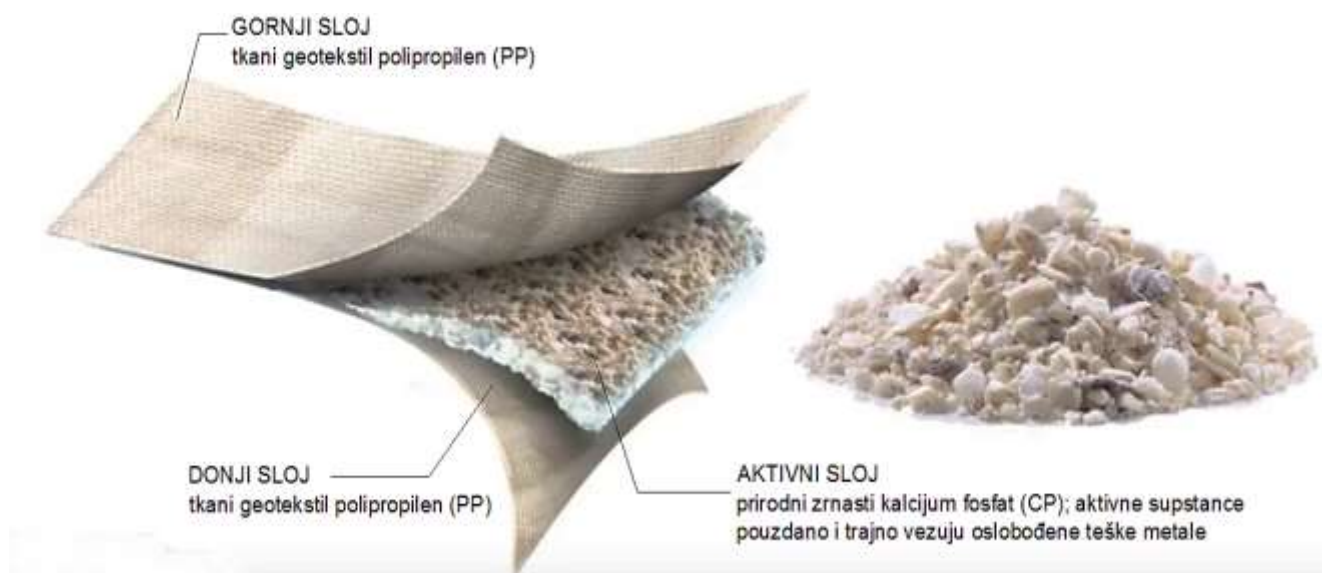
Slika 7. Prikaz sastava Tektoseal Active CP sistema
