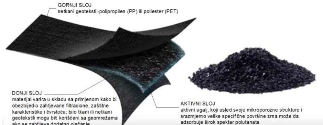
Slika 5. Prikaz sastava Tektoseal Active AC sistema
