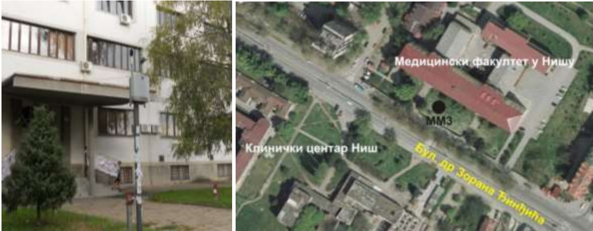
Slika 2. Terminal za monitoring buke montiran na zasebnom stubu (levo), lokacija terminala (desno)
