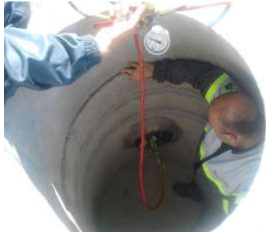
Slika 16. Ispitivanje vododrživosti – nepropusnosti kanalizacionih cevi vazduhom
