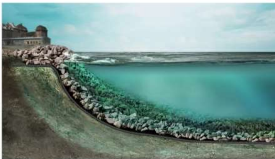
Slika 6. Prikaz načina postavljanja i fiksiranja Tektoseal Activ AC-a prilikom zaštite sedimenata od mogućih polutanata iz vode
