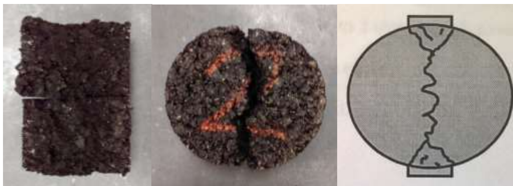
Slika 10. Vrsta loma uzorka asfaltne mešavine AB 11s
