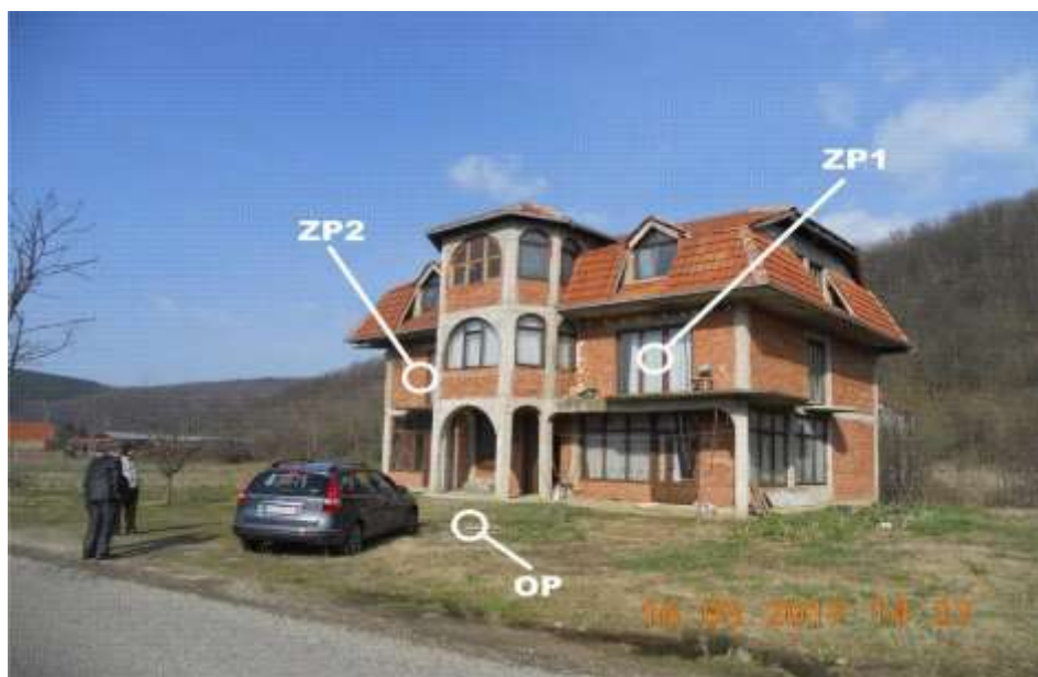
Slika 8. Položaj mernih mesta za ocenu stanja nivoa buke na ispitivanoj lokaciji Izvor: [2]
