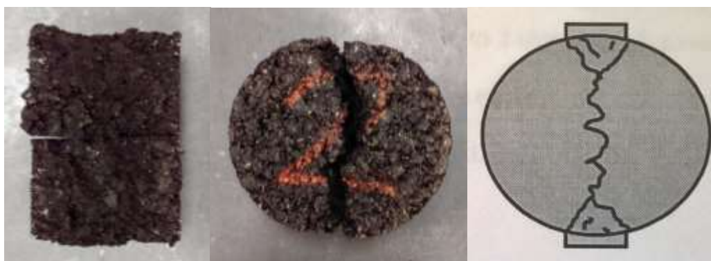
Slika 12. Vrsta loma uzorka asfaltne mešavine AB 11s
