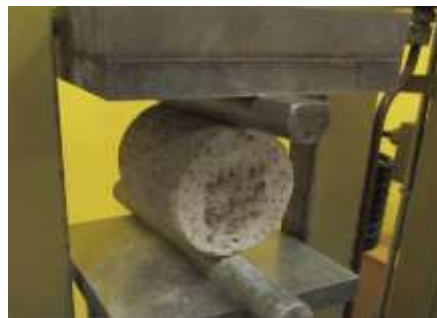
Slika 7. Laboratorijsko ispitivanje ITS-a (brazilski opit cepanja)
