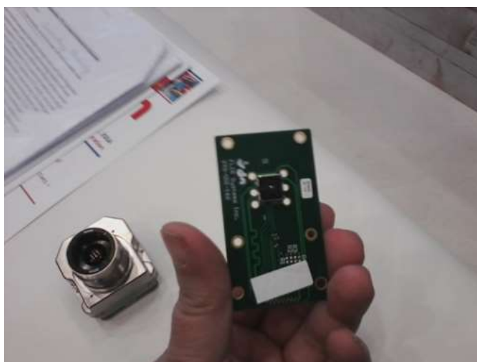
Слика 1. Термовизијска камера за пешачки прелаз са припадном електронском плочом (Извор: презентација на штанду произвођача, IntertrafficAmsterdam 2014, приватна колекција аутора)
