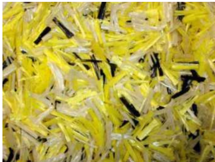
Slika 1. Vlakna od aramida i poliolefina (FORTA FI®)
