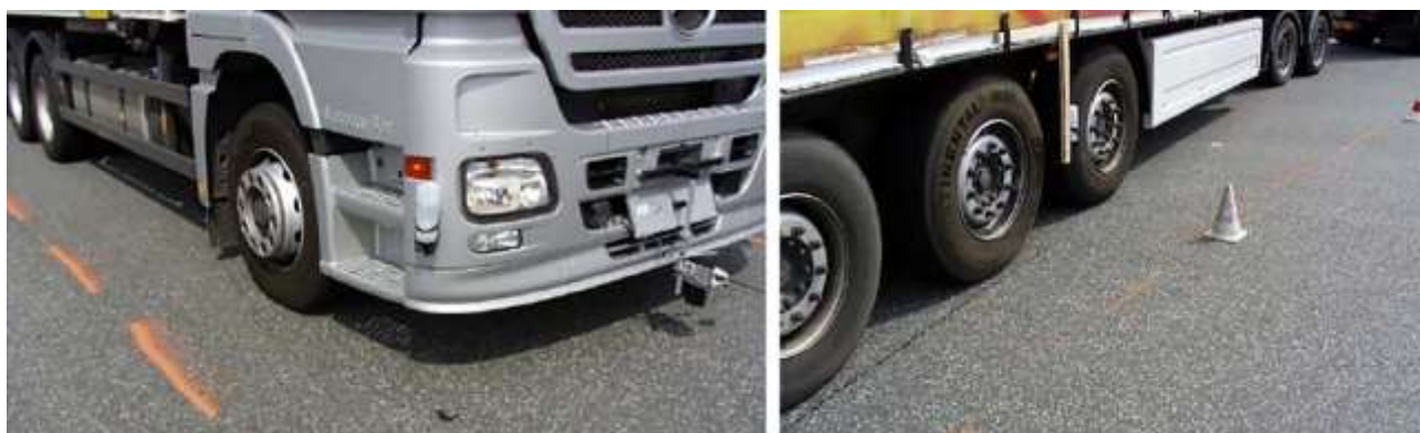
Slika 2. Postavljanje rezervoara sa vodom na mestima najisturenijih tačaka na vozilu [14]
