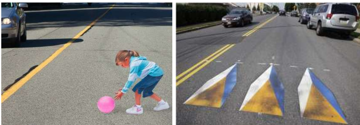
Слика 2. Фотографије 3Д хоризонталних ознака коришћених у експерименту
