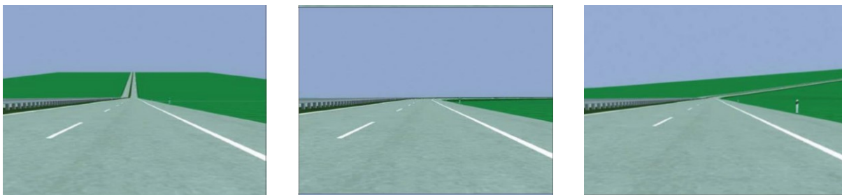
Slika 4. Primena neadekvatnog radijusa vertikalne krivine [4]
