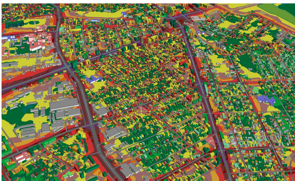
Slika 5. Prikaz jedne probne iteracije proračuna u softveru SoundPLAN 8.2 (Boja objekta odgovara nivou buke na najizloženoj fasadi) Izvor: (Strateške karte buke – Grad Novi Sad, 2022)
