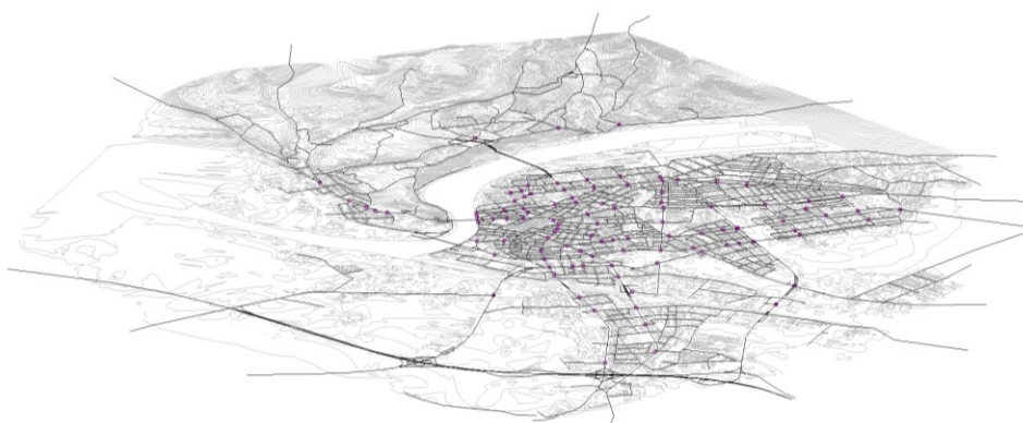
Slika 3. Prikaz izohipsi terena sa trasama drumskog saobraćaja u softveru SoundPLAN 8.2. Izvor: (Strateške karte buke – Grad Novi Sad, 2022)
