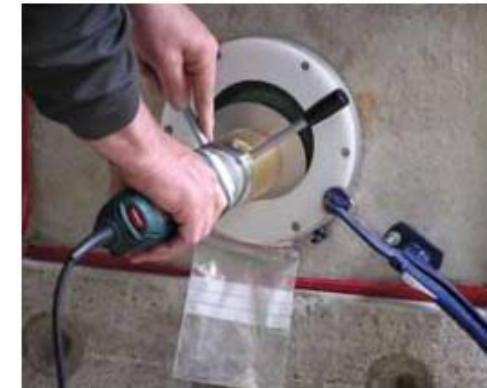
Uzimanje uzorka in-situ za formiranje hloridnog profila
