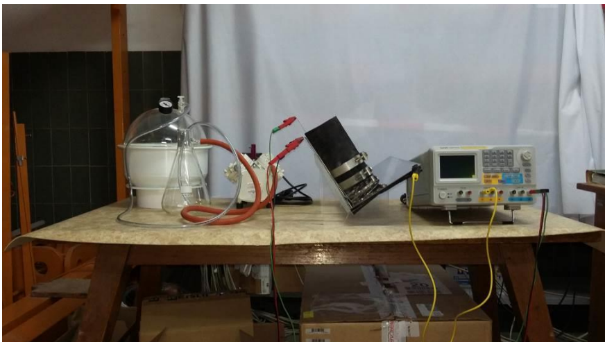
Ispitivanje otpornosti na dejstvo hlorida
