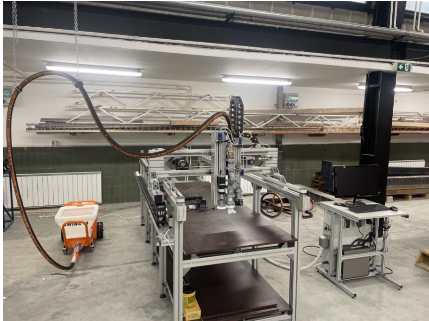
3D printer at FCE BG / 3D štampač betona na Građevinskom fakultetu u Beogradu
