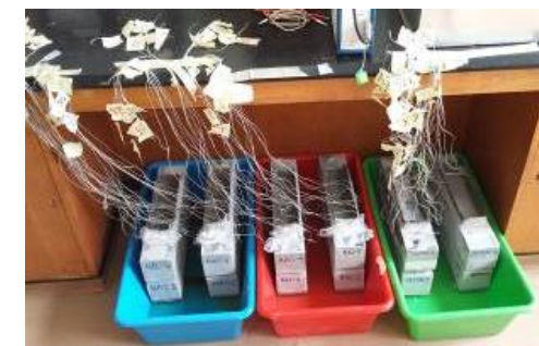
Ispitivanje stepena korozije armature
