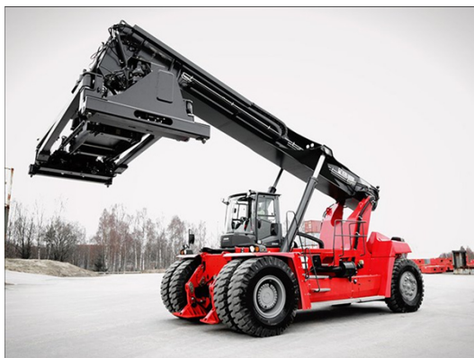
Слика 4: Изглед једног данашњег „Reach stacker”-а
